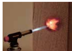
BPS断熱材 （水酸化アルミ混入型ポリスチレン）
