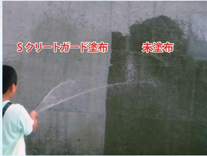
試験施工から 10 年経過後の追加試験の様子
